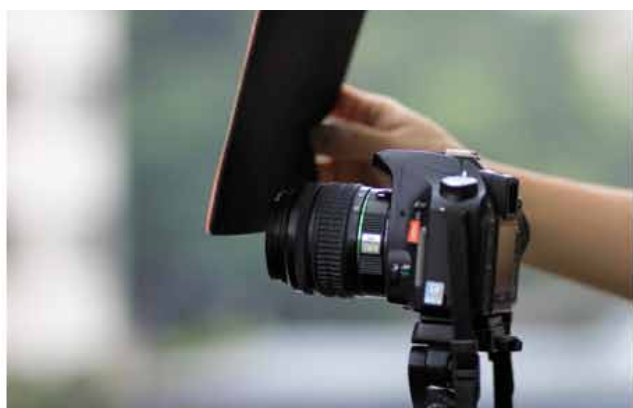
圖9.在反差的中间線偏下，上下快速來回微幅搖動，主要是防止黑卡線。
