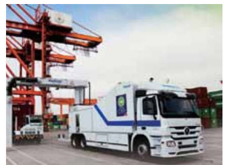
圖為我國海關現使用之移動式貨櫃檢查儀-大型X光機卡車就貨物存放地點，進行大型貨櫃儀器查驗。
